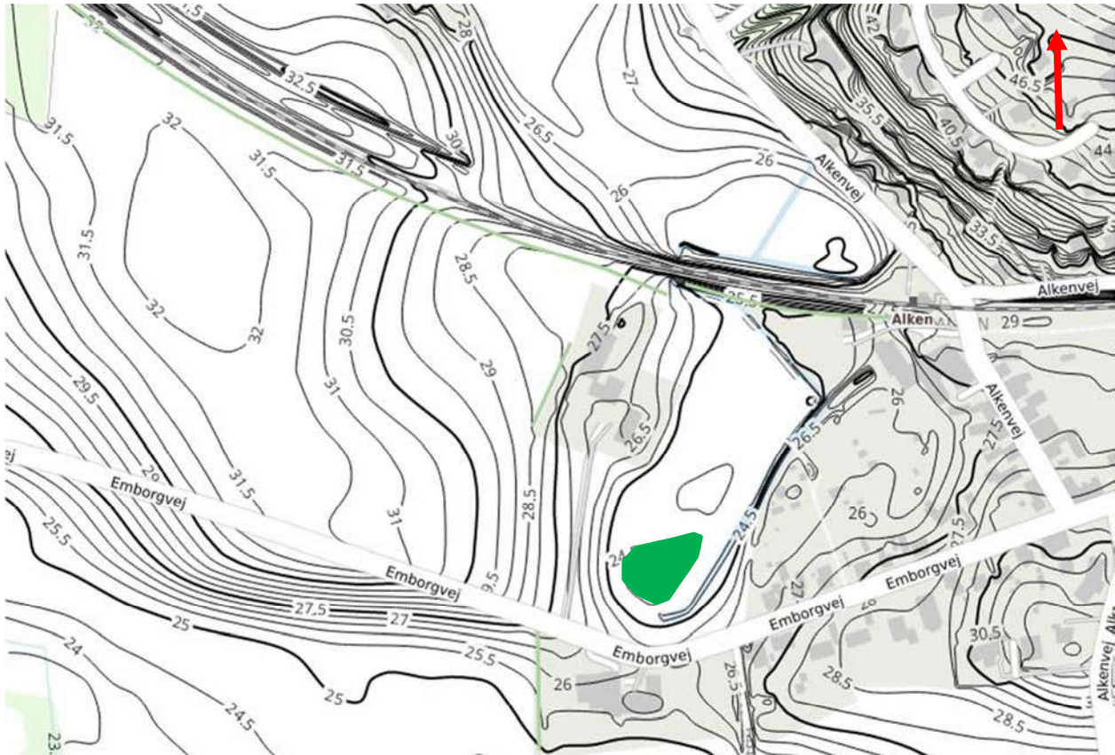
Figur 5, Højdemodel, med højdekurver pr. 0,5m samt nordpil.
