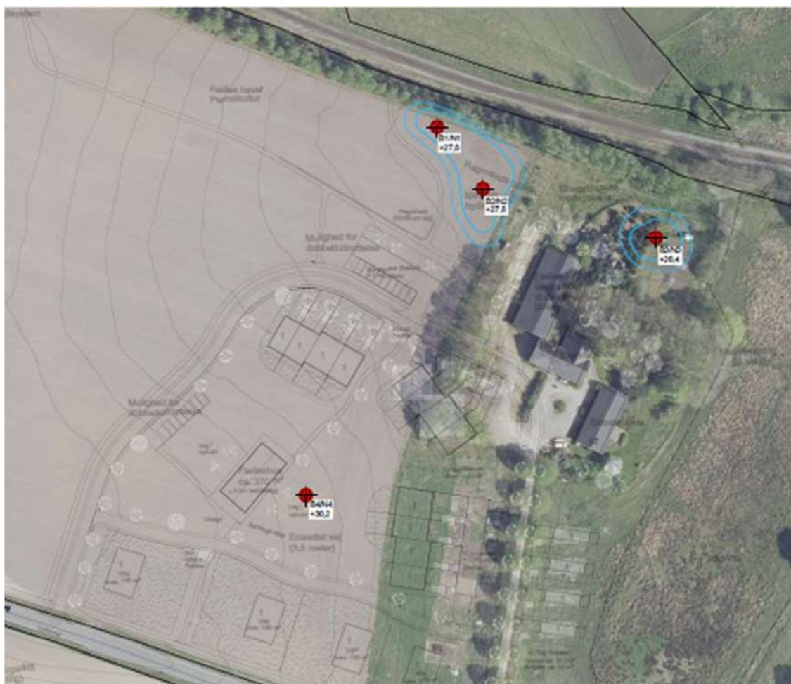
Figur 7, Placering af geotekniske borer udført af 4AP.
